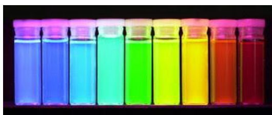
Figura 2.11: Exemplo de emissão luminescente por soluções nanométricas de CdSe/ZnS, processo de quimioluminescência [39].
