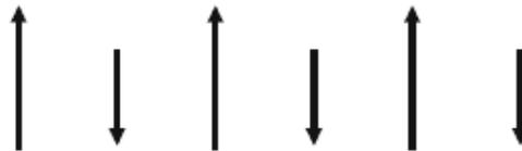
Figura 2.4.2 – Ordenamento ferrimagnético em  $T = 0$  K [Nolting, 2009].
