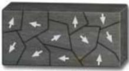
Figura 9: Domínios Magnéticos desordenados. Adaptado da ref [12].
