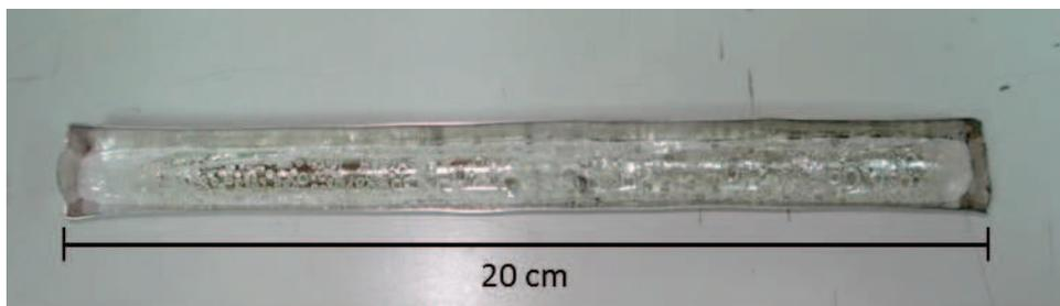
**Figura 3.2:** Foto do monocristal de  $BaY_2F_8$  dopado com 2 % de  $Tm^{3+}$  (Mello, 2008).
