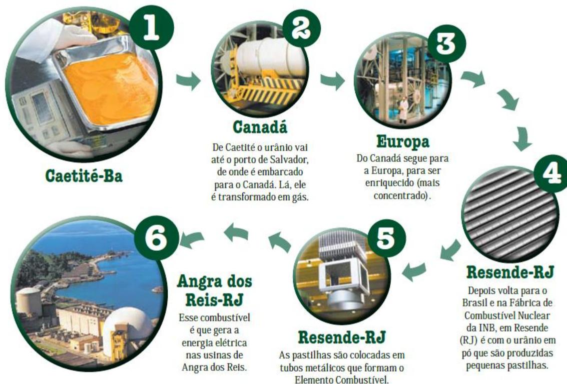
Figura 2.4: Ciclo do urânio obtido na mina de Caetité. Fonte: DAQUI (2009b).
