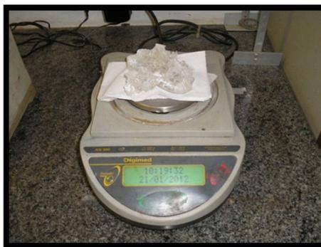
Figura 20. Balança utilizada durante procedimento de pesagem das amostras de parafina e acrílico.
