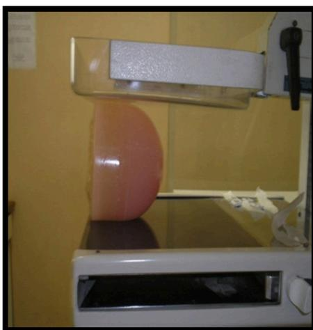
Figura 25. Simulador com implante posicionado para exposições, com compressor servindo apenas para imobilizá-lo.
