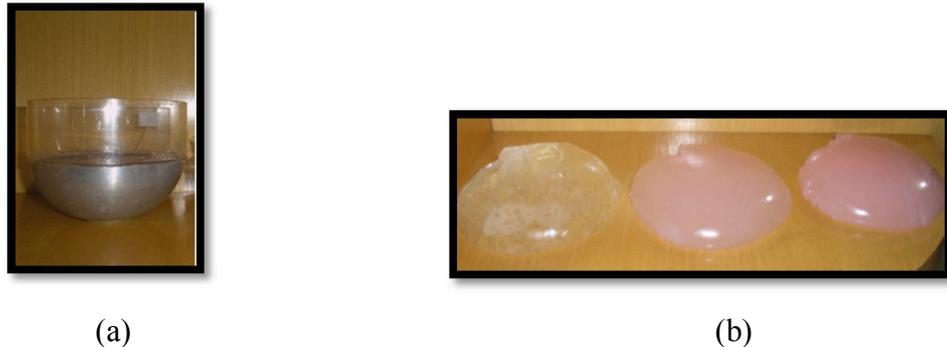
Figura 22. (a) Molde utilizado na confecção dos simuladores; (b) *Phantoms* montados com diferentes proporções de acrílico (da esquerda para a direita: parafina, parafina + 3% acrílico, parafina + 10% acrílico).
