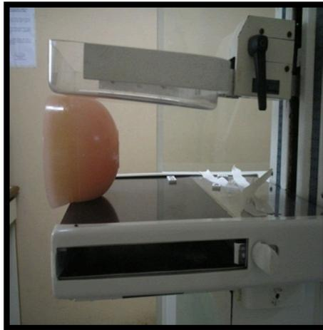
Figura 27. Simulador com implante posicionado para exposições, com compressão de 1 cm e deslocado 2,5 cm para fora da área exposta.
