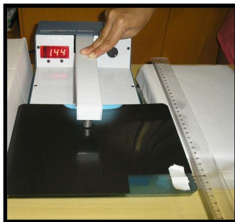
Figura 28. Aparato montado para medições da densidade óptica. Nesta fotografia observa-se um filme sobre o densitômetro; o filme analisado é um dos obtidos com simulador deslocado.
