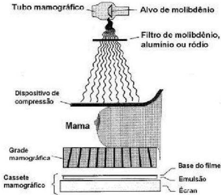
Figura 2.5 - Esquema de um aparelho mamográfico para realização do exame. (ROSA, 2005)
