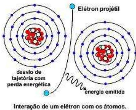
Figura 2.2 - Formação de raios X de *bremsstrahlung* (OLIVEIRA, 2010).
