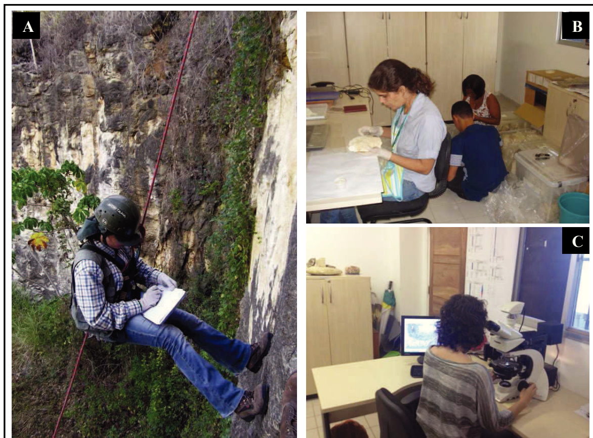
Figura 7: Atividades efetuadas para a descrição detalhada dos afloramentos estudados. A) Levantamento de perfil litológico nos paredões das pedreiras com utilização de técnicas de descida vertical; B) Descrição de amostras de mão em laboratório; C) Descrição de lâminas delgadas em microscópio petrográfico com equipamento fotográfico acoplado.
