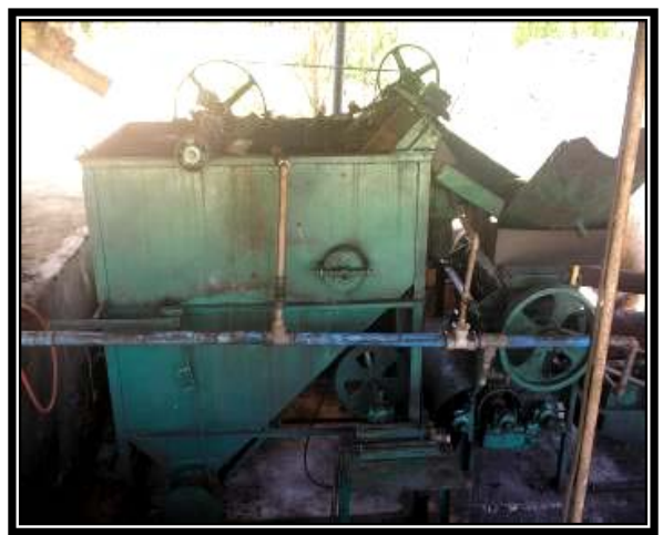
Fotografia 4: Despulpador de café da Fazenda Granja em 2008. Fonte: MACEDO, Verônica F. Trabalho de campo, março de 2008.
