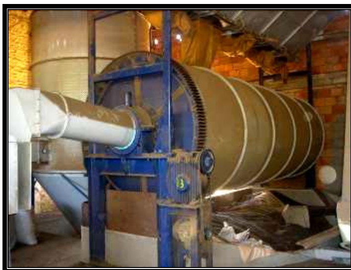
Fotografia 8: Máquina de secagem do café da Fazenda Jaguar em 2008. Fonte: MACEDO, Verônica F. Trabalho de campo, março de 2008.
