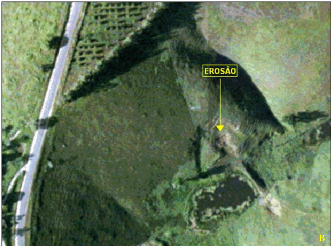
Figura 57 B. Erosão no sopé das vertentes.
