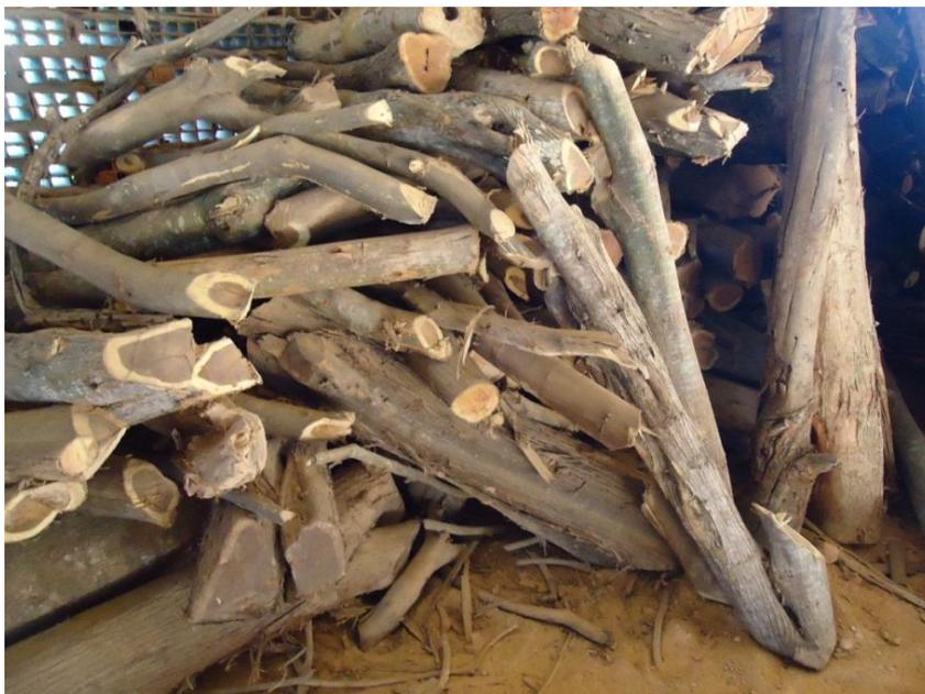
Eucalipto utilizado para a queima da cerâmica.
