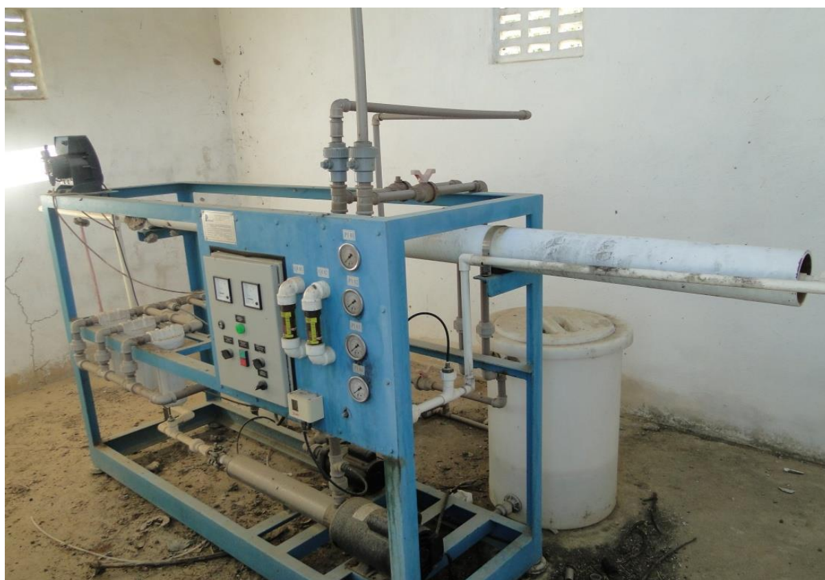
Figura 21: Equipamento de dessalinização da água subterrânea na seção do ACBHS. Fonte: SOUSA SILVA, L. C., 2013.
