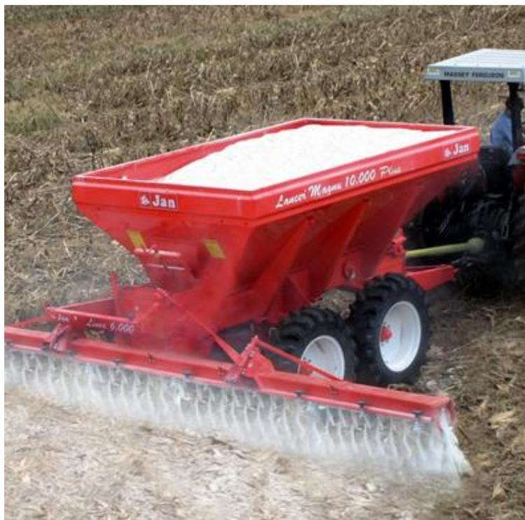
Figura 06: Máquina distribuidora de calcário.
