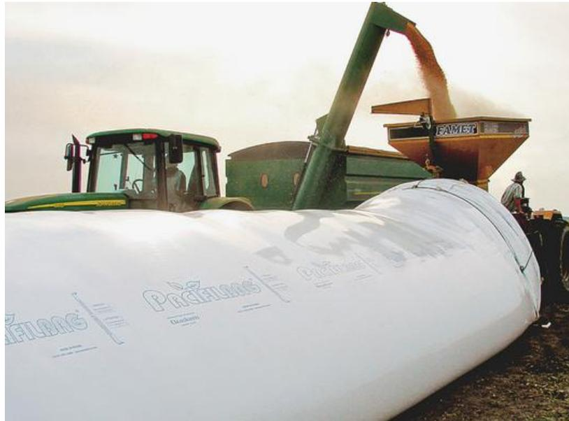
Figura 26: Máquina enchendo silo bag com milho.
