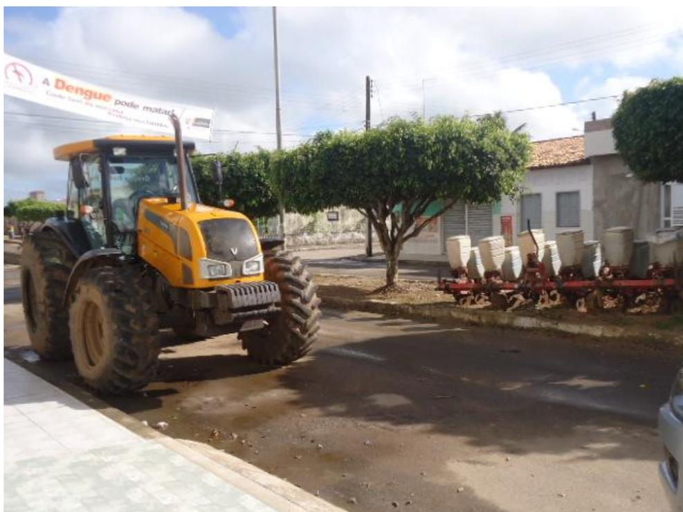
Figura 07: Máquina semeadora tracionada por trator.
