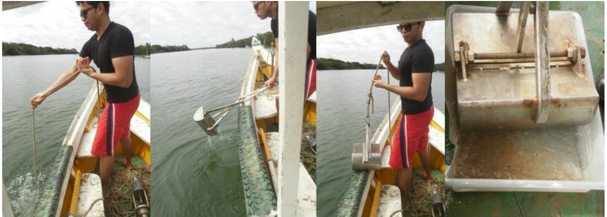
Figura 13 – Coleta utilizando draga do tipo Petersen
