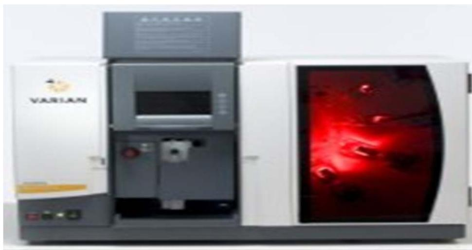
Figura 10 - Espectrômetro AA 240FS utilizado na determinação dos metais
