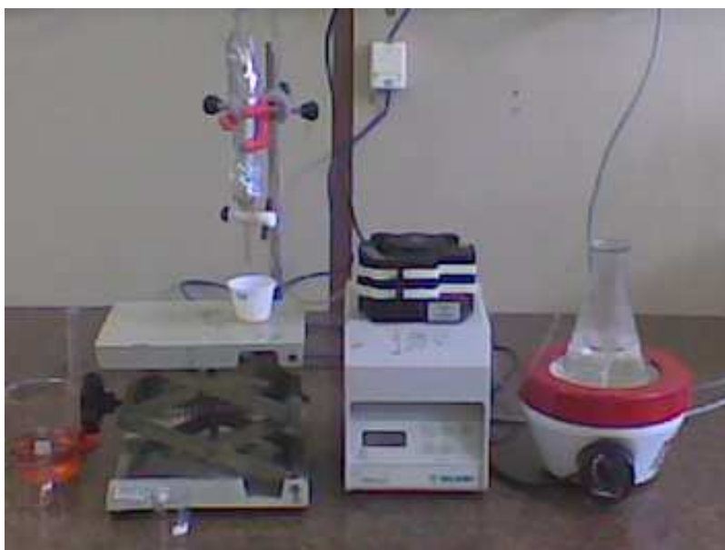
Figura 12 – Aparato experimental para o estudo da dessorção térmica.
