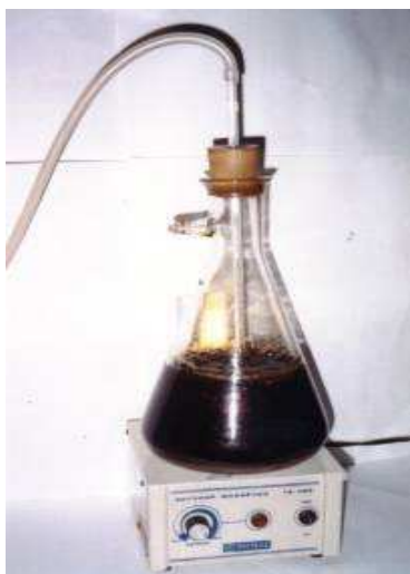
Figura 8 - Sistema extrator utilizado na extração de substâncias húmicas de solo.
