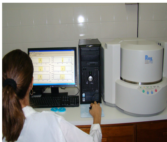
Figura 34. Detalhe do espectrômetro de fluorescência de raios X por energia dispersiva do Laboratório de Ensaios Inorgânicos do ITPS
