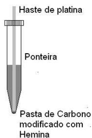
**Figura 9.** Esquema de construção do biossensor a base de hemina.
