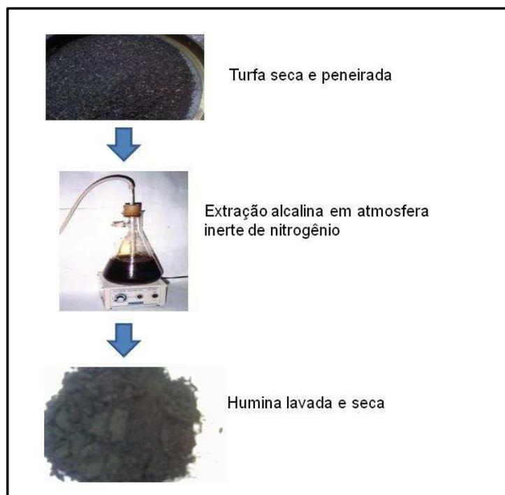
**Figura 4:** Extração da humina em meio alcalino.
