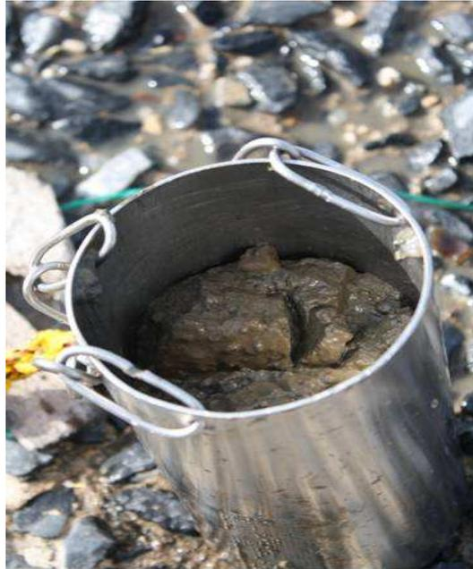
Figura 3: Amostrador tipo draga utilizado na coleta de amostra de sedimento superficial
