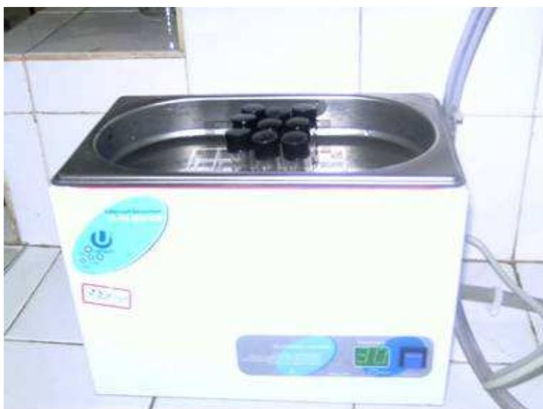
Figura 6: Banho de ultra-som utilizado na extração dos HPAs em amostra de sedimento
