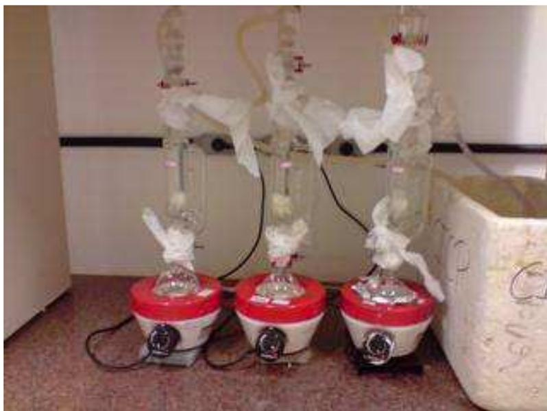
Figura 4: Ilustração do procedimento de extração de HPAs de sedimento utilizando a técnica Soxhlet
