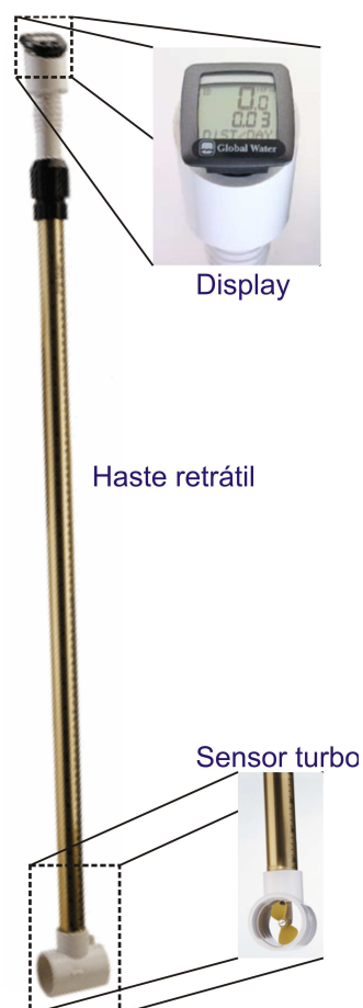
FIGURA 52. Micro-molinete Global Water modelo FP101.
