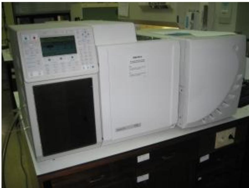
**FIGURA 7:** Cromatógrafo Gasoso (Varian, Modelo 4000)
