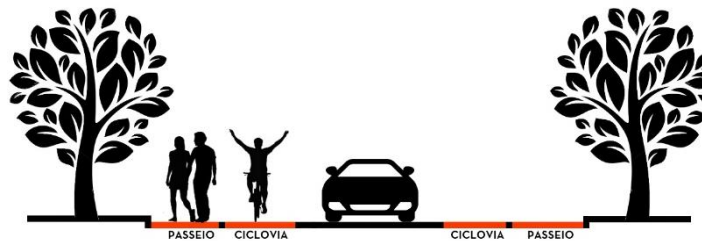
Figura 31 – Corte da via mista de mão única.
