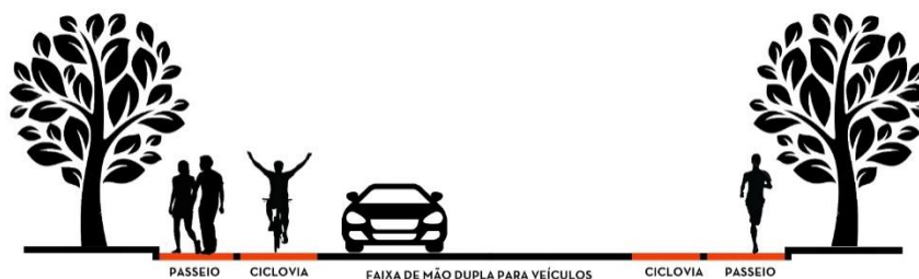
Figura 32 – Corte da via mista de mão dupla.
