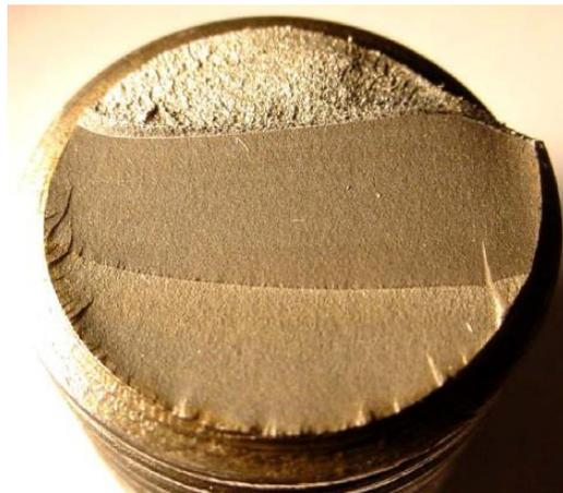
Figura 6 - Superfície de falha por fadiga. Região superior bastante áspera demonstrando a fratura final, demais zonas com marcas de praia de propagação da trinca. Fonte: (Griza, 2013).
