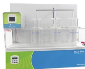
Figura 3. Desintegrador utilizado para a realização do teste.
