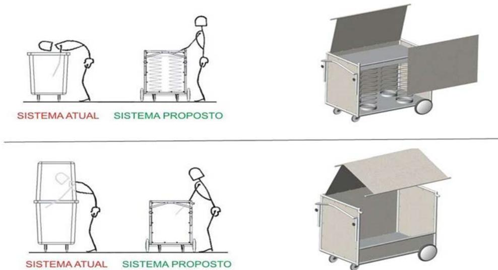
**Figura 1** – Novos sistemas para transporte de roupa limpa e para transporte de roupa suja e suas melhorias no sistema, respectivamente.
