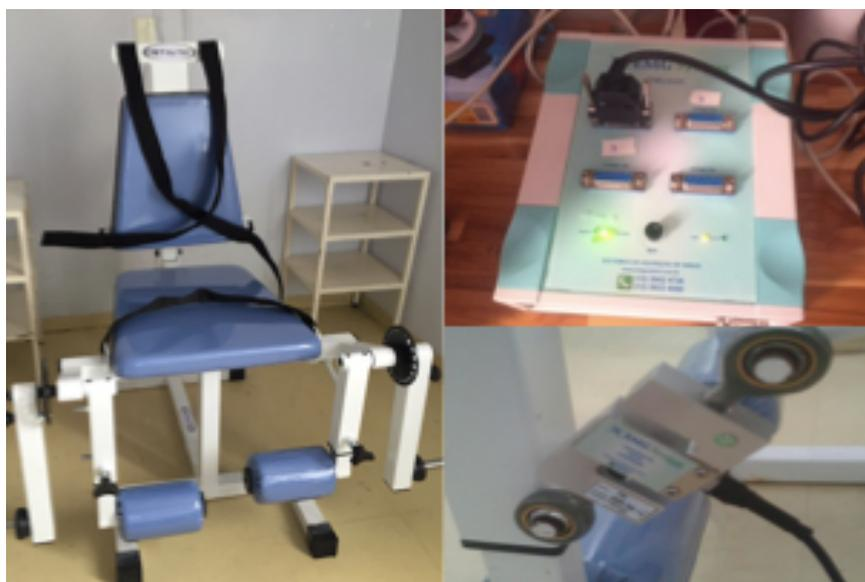
**Figura 2.** Cadeira extensora, célula de carga e sistema de transmissão de sinais para realização da avaliação de força isométrica para extensão de joelho.
