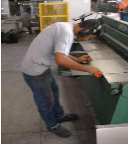
Figura 6 – Operador coloca a chapa na bancada
