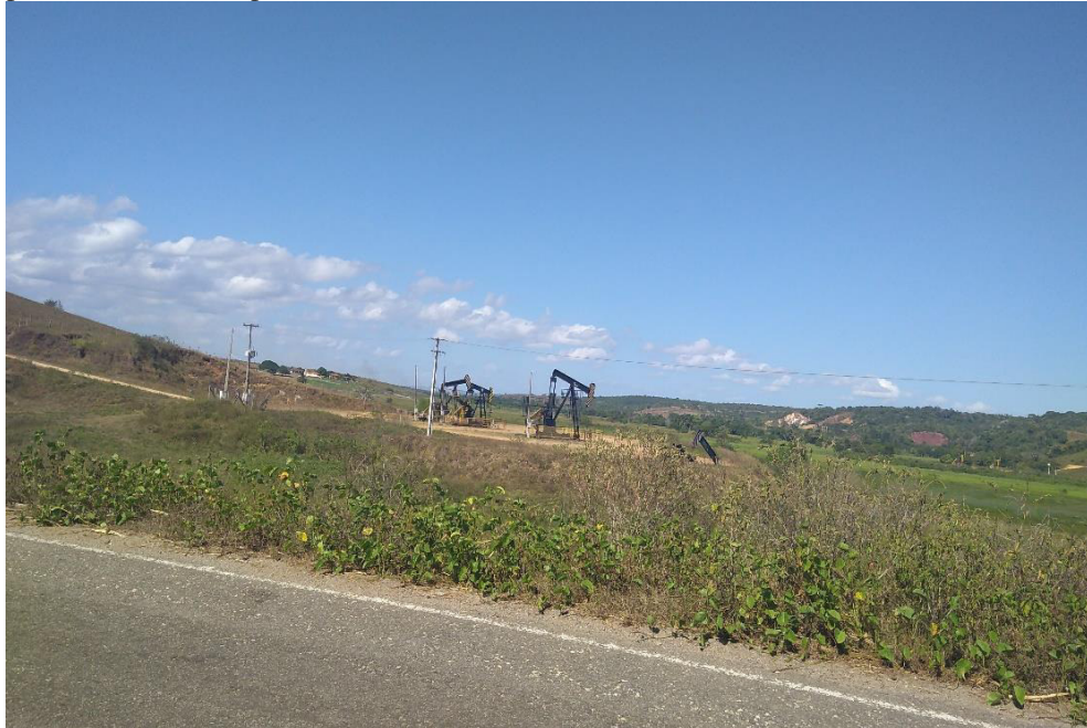
Figura 28 - Bombeamento do petróleo, através de elevação artificial, em poços de produção próximos entre si, Japarutuba.
