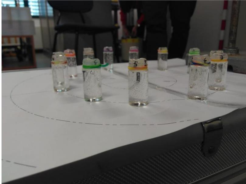
**Figura 27** Detectores de bolhas após a irradiação de 7 h com fonte de nêutrons AmBe.
