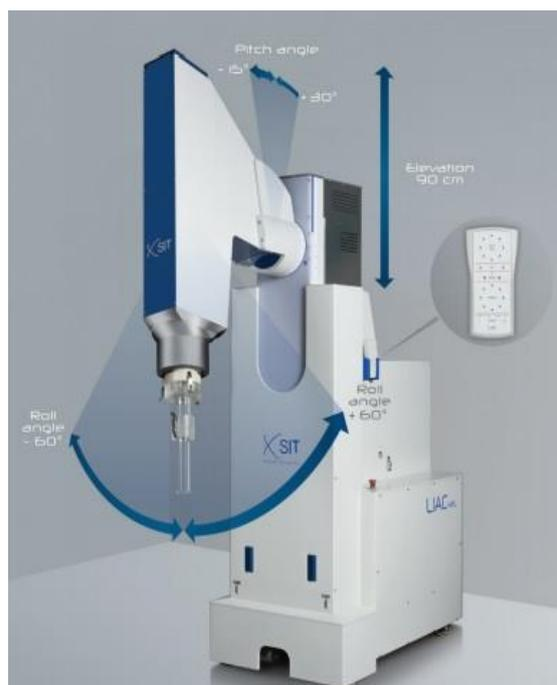
**Figura 17** Unidade móvel, explicitando os graus de liberdade que a máquina possui.
