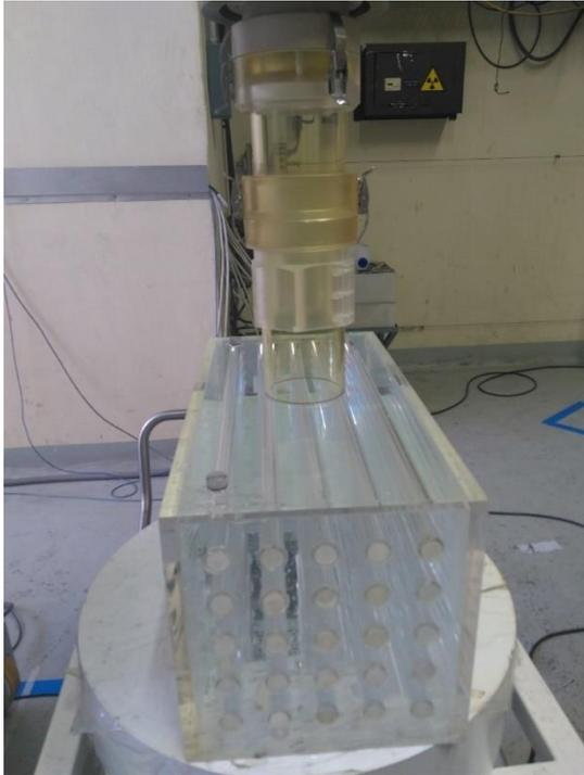
**Figura 18** Phantom utilizado no experimento com o LIAC HWL com o aplicador de 60 mm.
