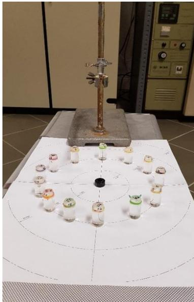
**Figura 25** Aparato experimental para calibração sem a fonte de nêutrons.
