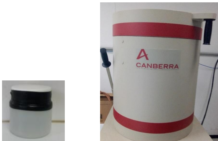
Figura 3.5 – Frasco de polietileno (F100) com a amostra (à esquerda) e detector de HPGe (à direita).
