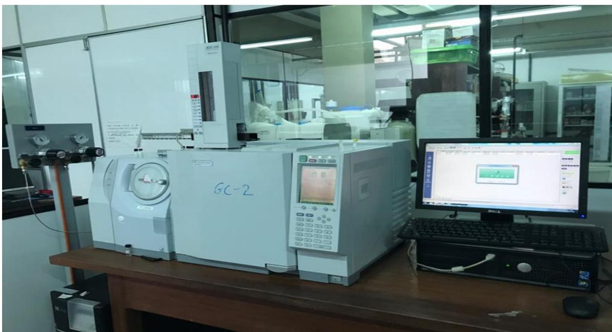
Figura 6: Aparelho Cromatografo Gasoso acoplada a espectrometria de massa (GCMS), Laboratório de Química da UFAL.
