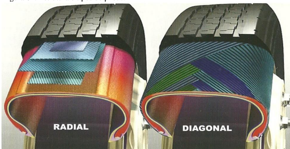
Figura 01: Estrutura e tipos de pneus.
