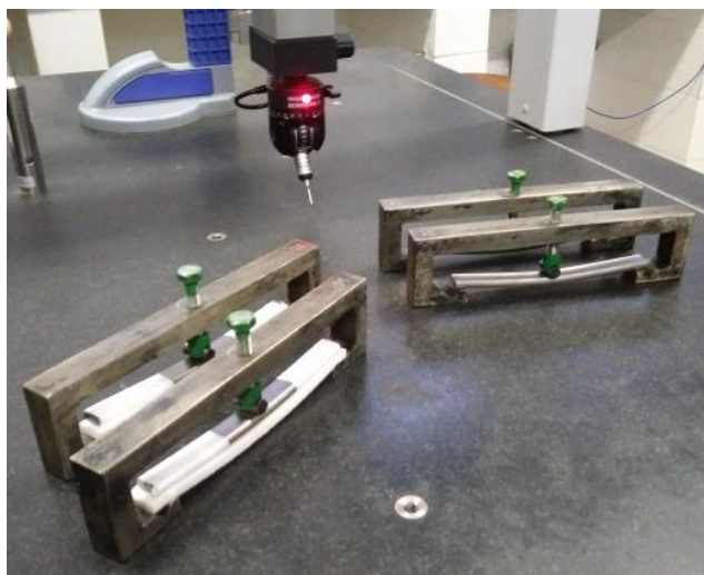
Figura 15 - Disposição das amostras após aplicação de flecha.
