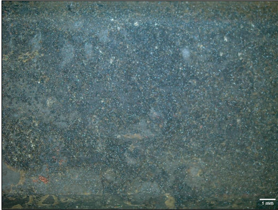
Figura 29 - Resultado de ensaio de partículas magnéticas por via seca em face superior tracionada de arame 2 livre.
