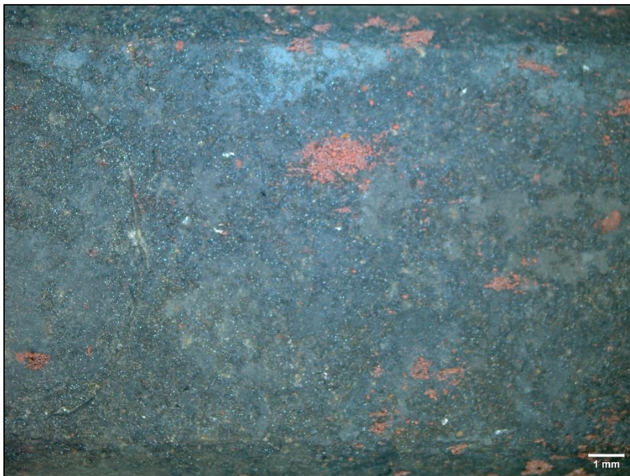
Figura 30 - Resultado de ensaio de partículas magnéticas por via seca em face superior tracionada de arame 2 com camada de PEAD.
