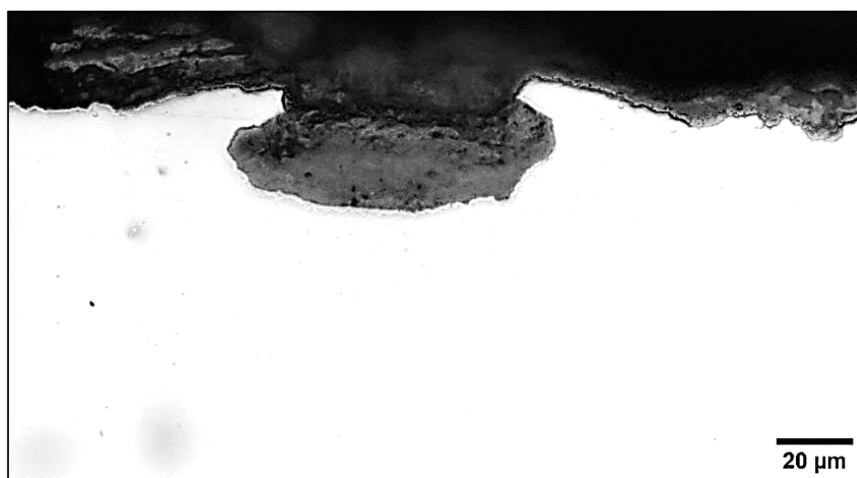
Figura 36 - Pite subsuperficial elíptico formado em amostra do arame 1 com PEAD.
