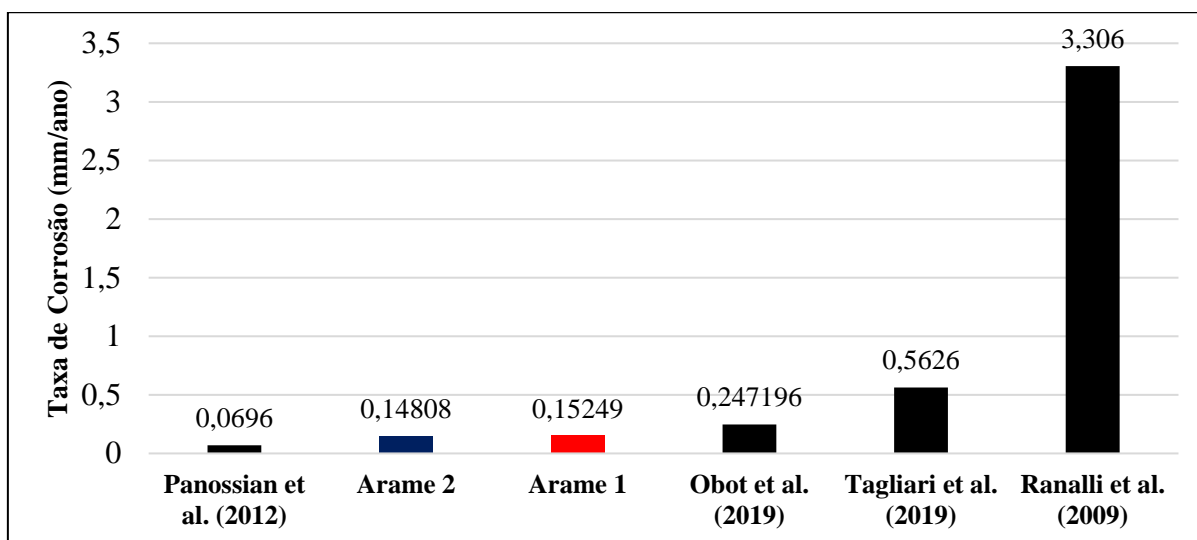
Figura 24 - Comparativo de taxas de corrosão equivalentes entre amostras e literatura.
