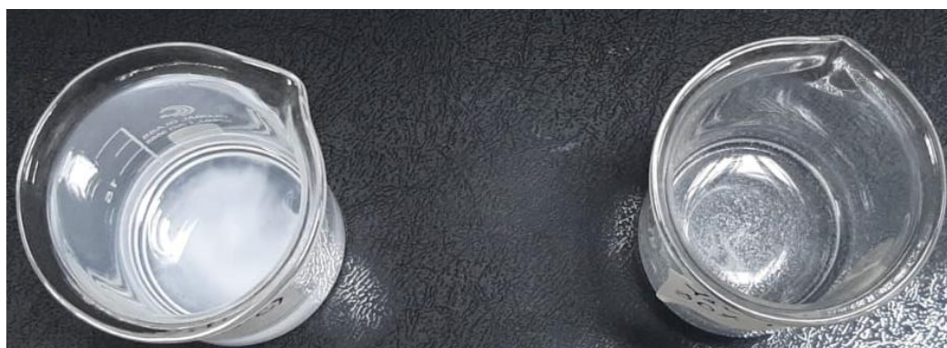
Figura 21 (b): Fotografia da vista superior do comportamento das amostras após 1 h da dispersão. À esquerda está a Y_2O_3 -Nd-pó (1000 °C) e à direita a Y_2O_3 -Nd-30%-PEG/NP).
