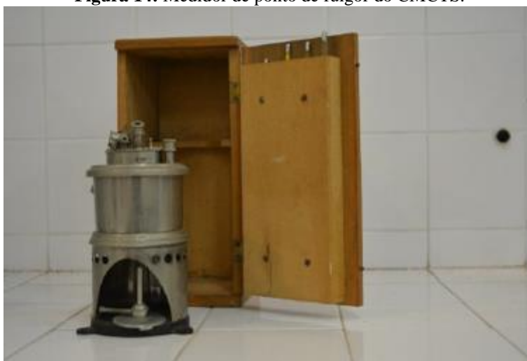
Figura 14: Medidor de ponto de fulgor do CMCTS.
