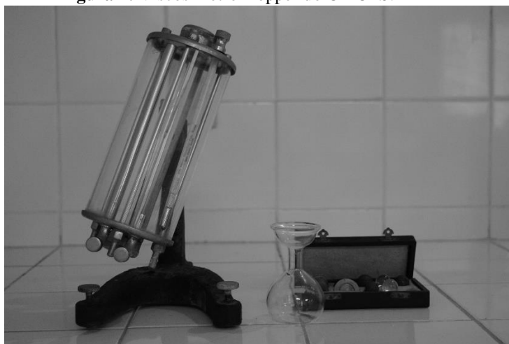
Figura 7: Viscosímetro Hopper do CMCTS.
