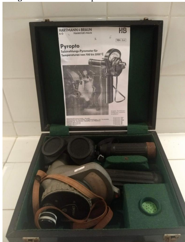
Figura 16: Pirômetro Ótico do CMCTS.
