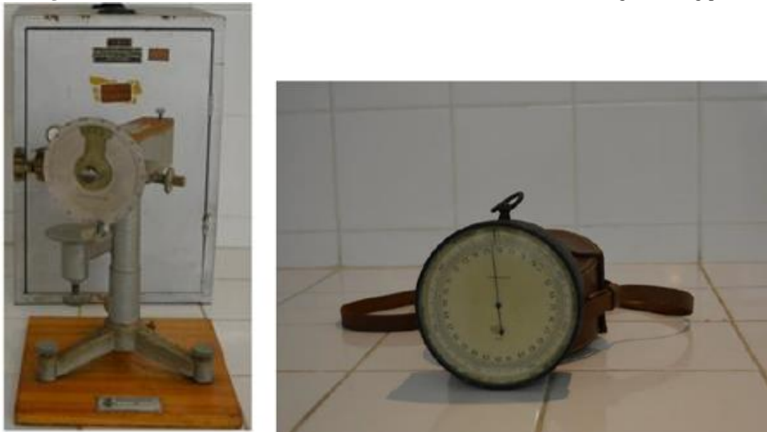
Figura 13: Penetrômetro K.I.C. do Centro de Memória da Ciência e Tecnologia de Sergipe.
