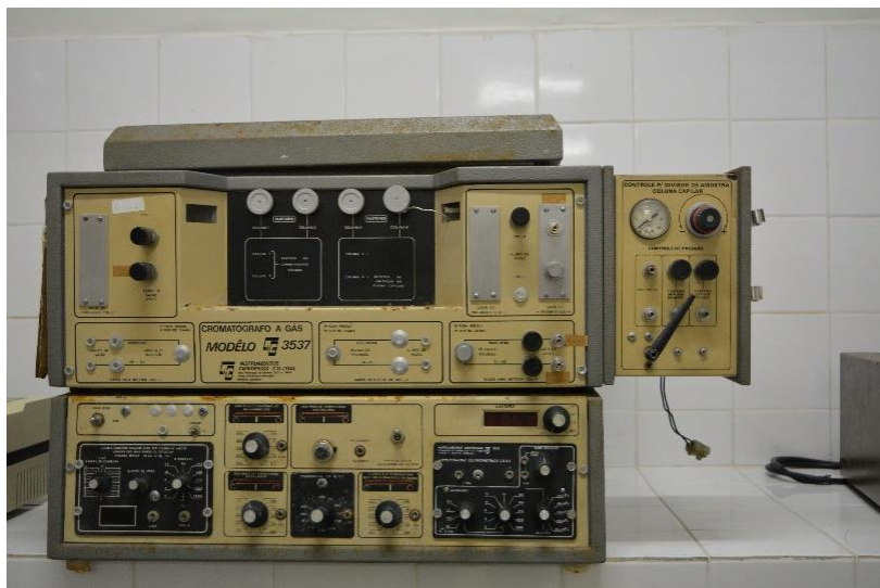
Figura 20: Cromatógrafo a gás modelo C.G. Ltda. Utilizado pelo laboratório de química orgânica do ITPS.
