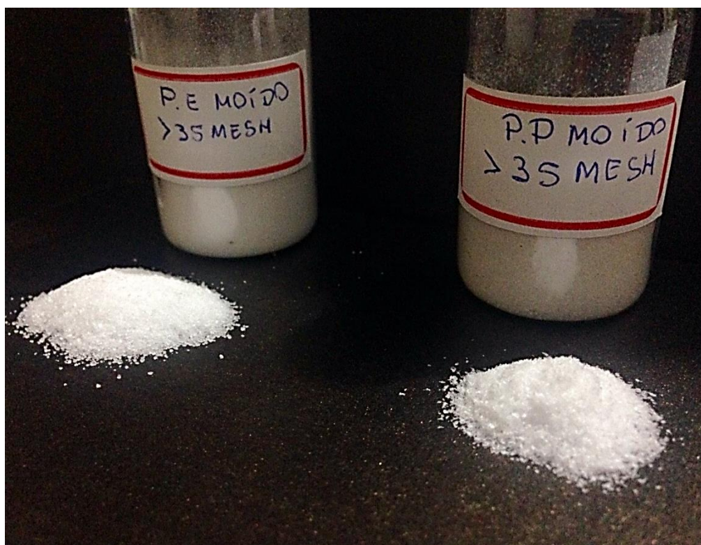
Figura 4.3.1 - Resinas dos polímeros pós-consumo (PEAD, PP) usadas no processo de pirólise.
