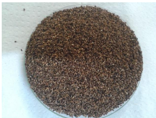
Figura 4.4 – Meio filtrante casca de nozes
