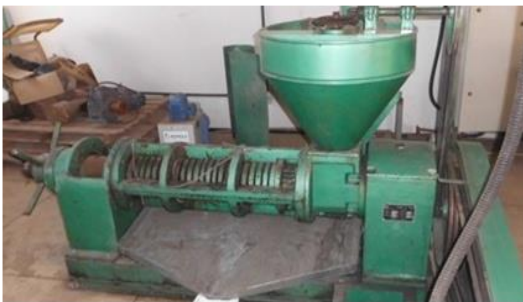
Figura 3.2 – Obtenção da torta de moringa por prensagem mecânica em extrusora.
