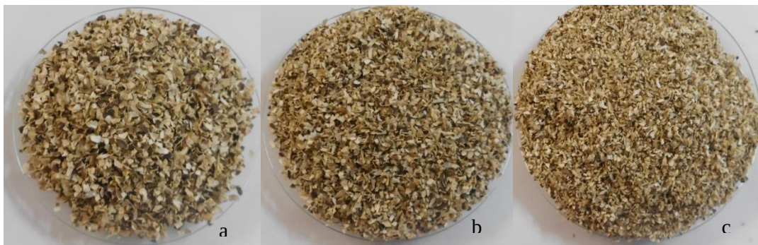
Figura 4.3–Meio filtrante casca da moringa, diâmetros: 1,70mm (a), 1,19mm (b) e 0,84mm (c).
