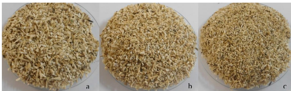
Figura 4.2–Meio filtrante vagem da moringa, diâmetros: 1,70mm (a), 1,19mm (b) e 0,84mm (c).
