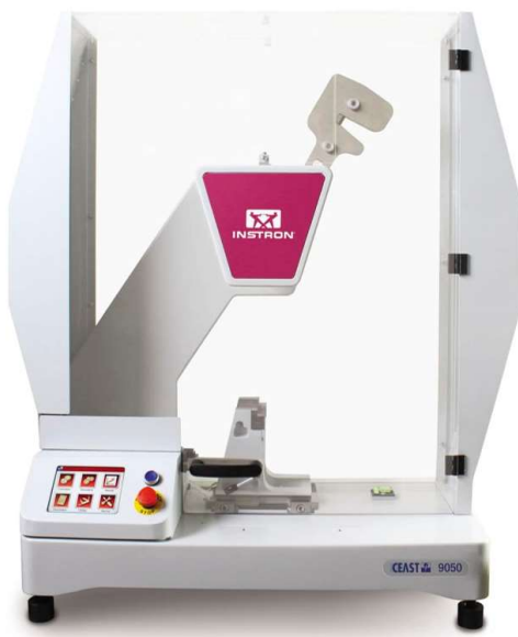
Figura 24 – Pêndulo Instron CEAST 9050
