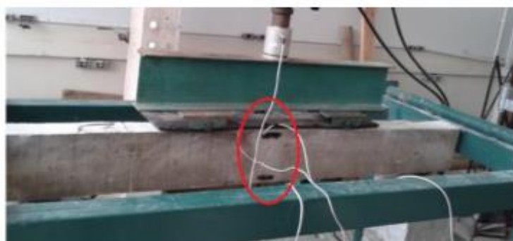
Figura 39: Posicionamento dos extensômetros.
