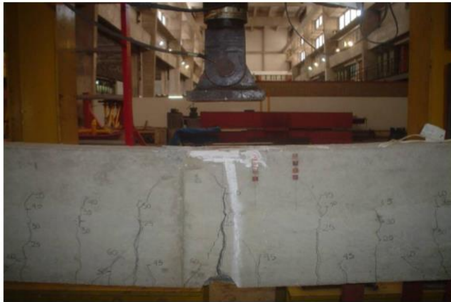
Figura 51: Ensaio de três pontos de Romero (2007).
