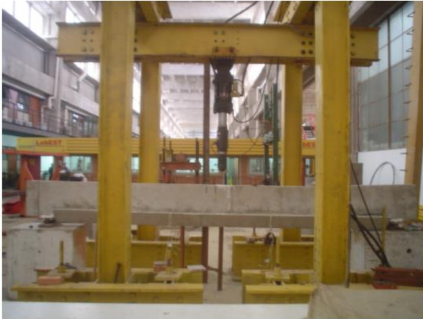
Figura 48: Ensaio de flexão em três pontos.
