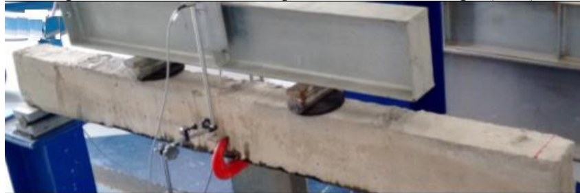
Figura 42: Ensaio de flexão simples de Fernandes e Vargas (2015).
