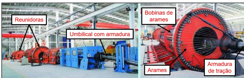
Figura 3 - Assentamento de armadura de tração por reunidoras planetárias. Fonte: ADAPTADO DE HERMAN [15]
