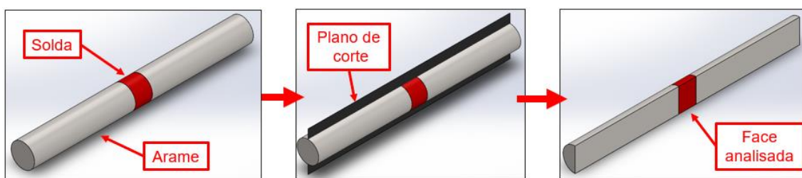
Figura 9 - Etapas para obtenção da face analisada na metalografia.
