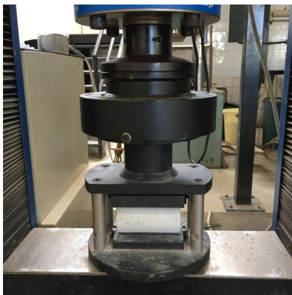
Figura 32 - Realização do ensaio de resistência à tração indireta
