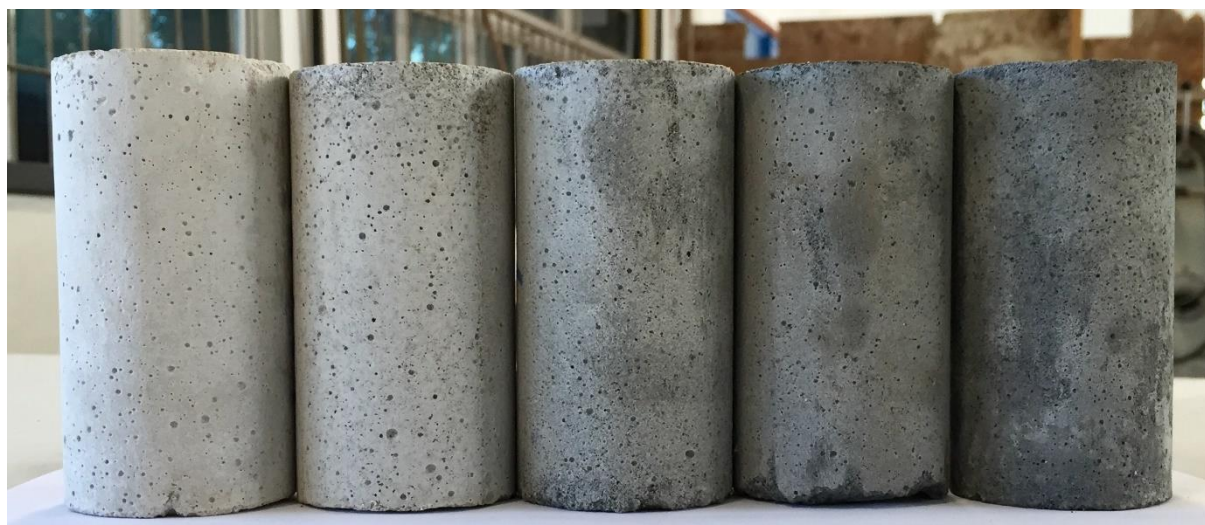
Figura 28 - Aspecto das argamassas de referência e da série com granalha batida fina
