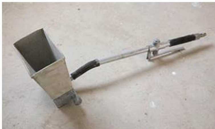
Figura 4 - Projektor por spray com recipiente acoplado
