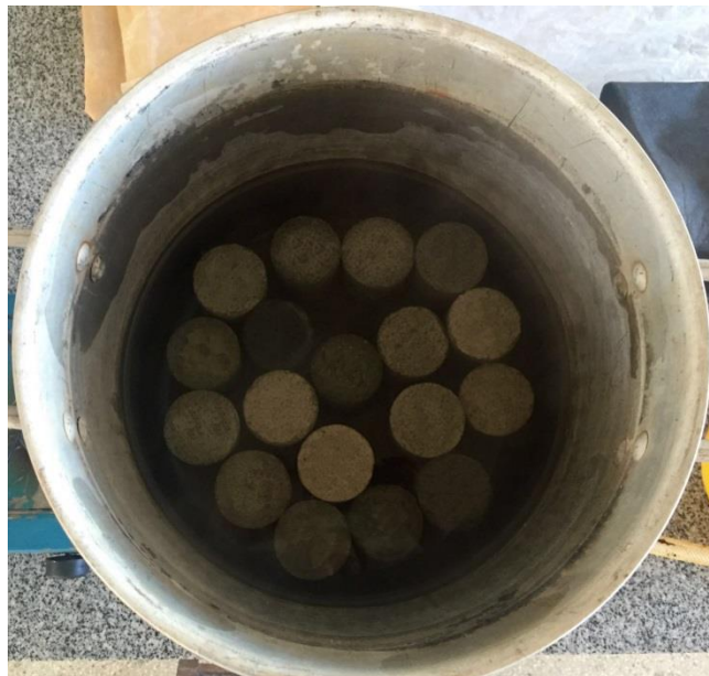
Figura 29 - Ensaio de fervura dos corpos de prova
