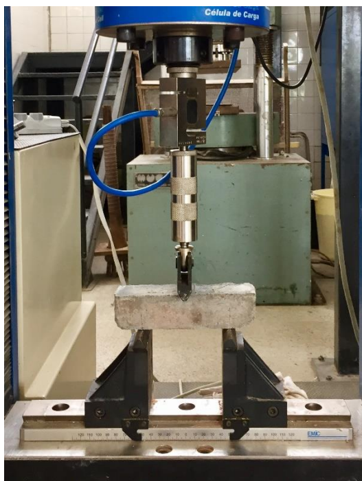
Figura 35 - Realização do ensaio de resistência à tração na flexão
