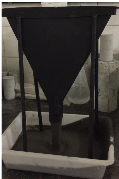
Figura 38 - Realização do ensaio do Mini Funil-V
