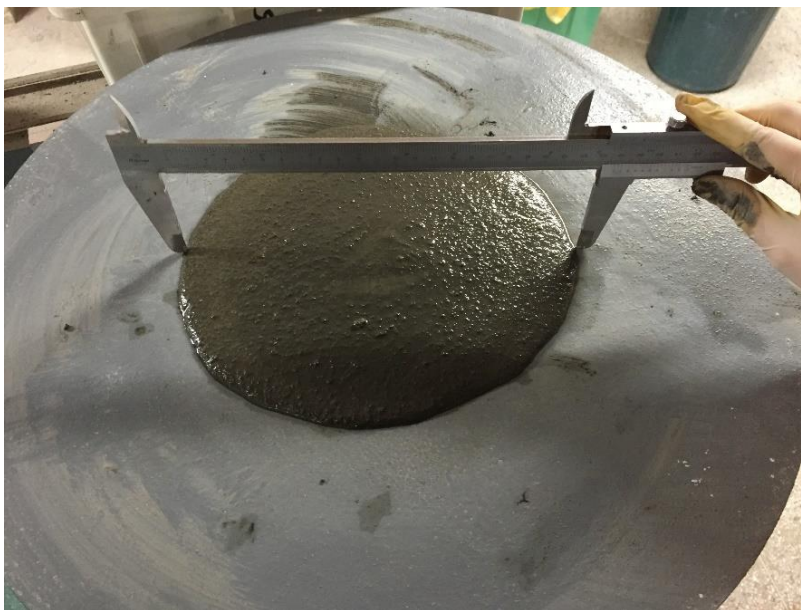
Figura 37 - Espalhamento da argamassa autonivelante no ensaio do Mini Slump-test
