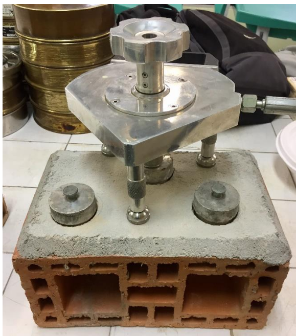
Figura 33 - Realização do ensaio de resistência potencial de aderência
