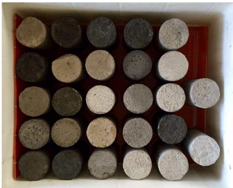
Figura 30 - Corpos de prova parcialmente imersos em água no ensaio de absorção por capilaridade
