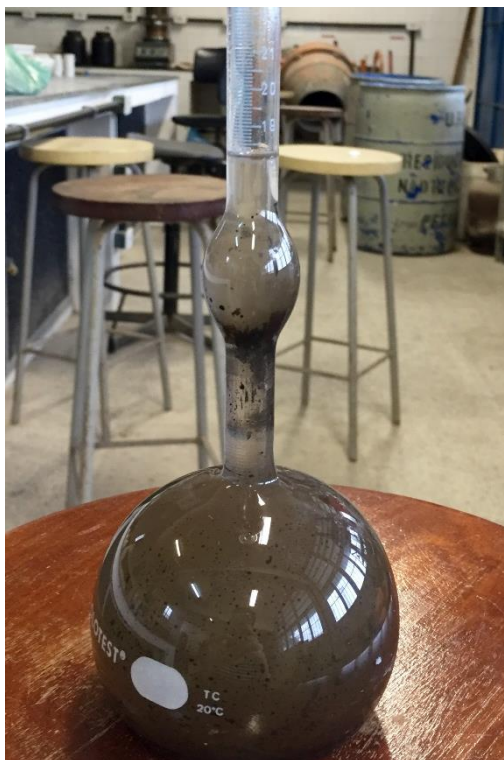
Figura 26 - Determinação da massa específica real da adição inerte
