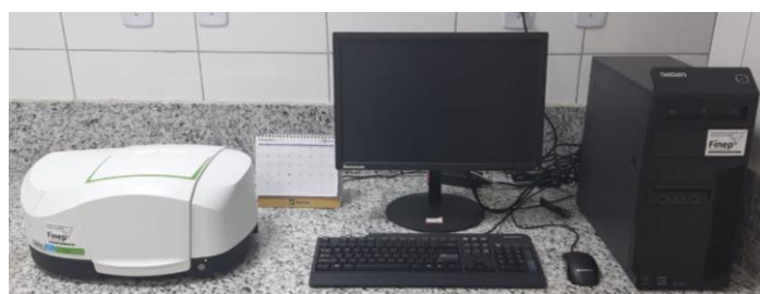
Figura 12. Espectrômetro de infravermelho da marca Perkin Elmer, modelo Spectrum Two do NEREES/SergipTec 1 . Fonte: elaboração própria.
