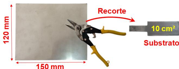
Figura 10. Chapa de aço inox 304 com espessura de 0,5 mm e seu recorte para obter o substrato com área de deposição de 10\text{ cm}^2 . Fonte: elaboração própria.
