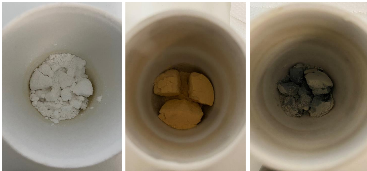
Figura 3 | Pós obtidos após calcinação a 900 °C. a) LZO900, b) LFZO900, c) LNZO900
