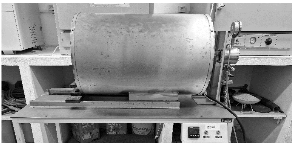
Figura 14. Forno de tratamento térmico.
