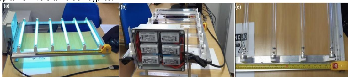
Figura 22 - Imagem real do equipamento de desinfecção UVC para o sistema AVAC instalado no Hospital Universitário de Lagarto.
