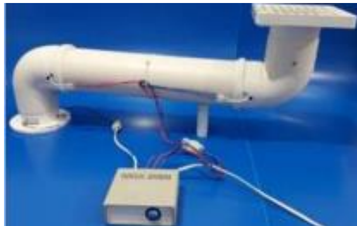
Figura 30 - Imagem real do dispositivo de desinfecção UVC montado
