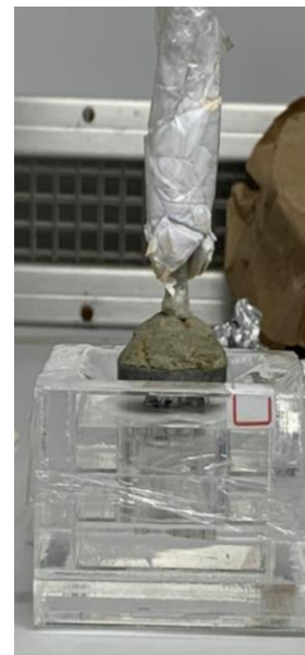
Figura 5.10 – Irradiação beta de raízes de Allium cepa no suporte de acrílico.
