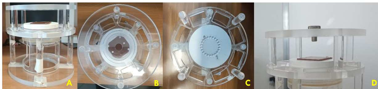
Figura 5.3 – Sistema de irradiação dos TLDs-100. (A) Vista completa do suporte sem a fonte de ^{226}\text{Ra} ; (B) Vista da parte superior do suporte; (C) Vista da parte inferior do suporte; (D) Vista completa do suporte com a fonte de ^{226}\text{Ra} .
