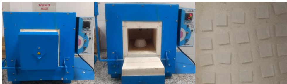
Figura 5.5 – Forno mufla utilizado para o tratamento térmico dos TLDs.
