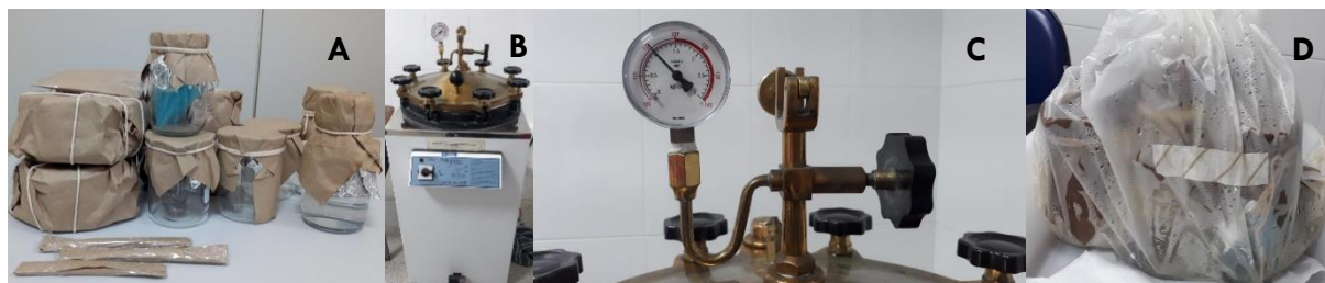
Figura 5.7 – Procedimento de autoclavagem de materiais: (A) Revestimento dos materiais com papel alumínio e papel madeira; (B) Equipamento de autoclave; (C) Equipamento de autoclave em funcionamento; (D) Materiais autoclavados.
