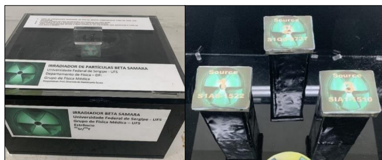
Figura 5.6 – Irradiador SAMARA com fontes de ^{90}\text{Sr}/^{90}\text{Y} .
