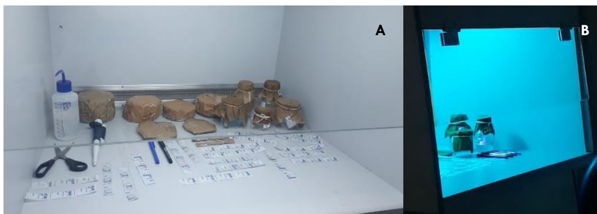
Figura 5.8 – Esterilização dos materiais com luz UVC. (A) Disposição dos materiais na cabine de fluxo laminar; (B) Exposição dos materiais à luz UVC.
