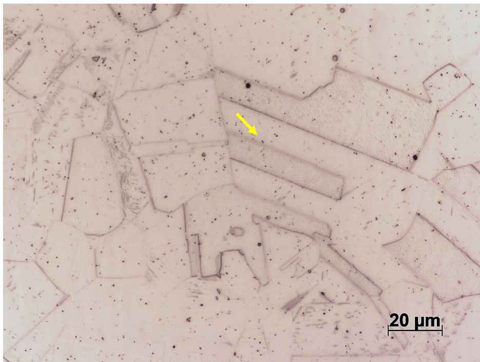
Figura 22: Microestrutura da chapa no sentido transversal da amostra após recozimento. Aumento de 500x. Seta amarela (macla de recozimento).
