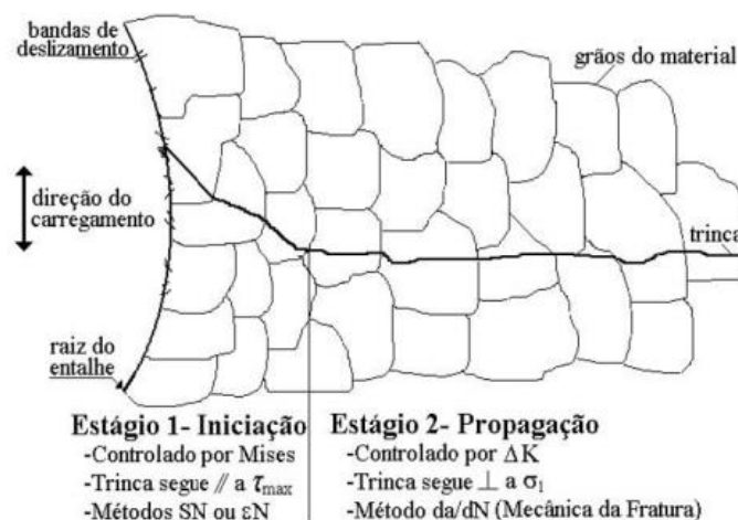
Figura 6: Corte esquemático dos estágios de iniciação (I) e propagação (II) da trinca por fadiga.
