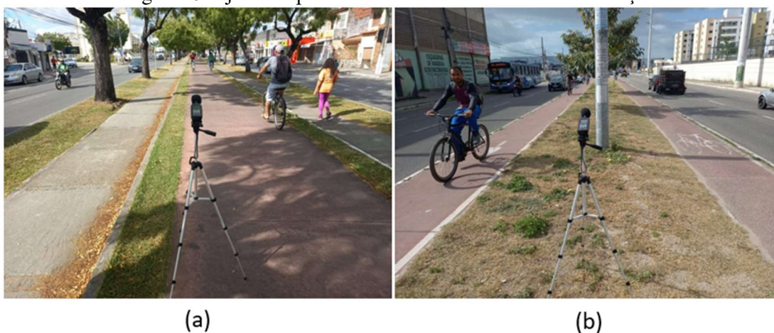
Figura 29-Ajuste de posicionamento do sonômetro nas medições
