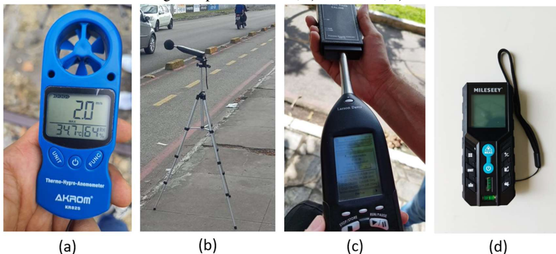
Figura 27-Equipamentos utilizados para coleta de dados acústicos: a) Termo-higro-anemômetro, b) Montagem tripé e sonômetro, c) Calibrador, d) Trena
