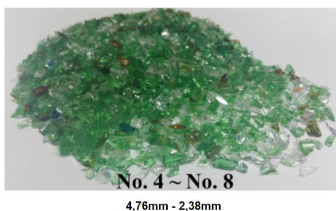
Figura 3.23 - Granulometria das partículas utilizadas no trabalho de Sun et al. (2021). (Fonte: Adaptado de Sun et al. , 2021).
